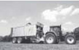
● Filegl Przyczepa z systemem zsuwającym asw 268 2011 r., Filegl Gigant C Dane techniczne: dopuszczalny ciężar całkowity: 20.000 kg ciężar własny: 6.500 kg ładowność: 13.500 kg pojemność napełniania bez ściśnięcia: 35 m3 pojemność napełniania ze ściśnięciem kieszonki:
