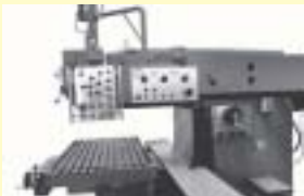
● MAHO DECKEL Maho 1100 2012 r., Dane techniczne powierzchnia robocza stołu[mm] 750x1250 ilość rowków w stole 10 szerokość rowka w stole[mm] 16 rozstawienie rowków w stole [mm] 44 przesuw wzdłużny ręczny/mechaniczny [mm] 1000/1000 przesuw poprzeczny[mm] 275, tel. 52 3722668, biuro@metalex.pl,
